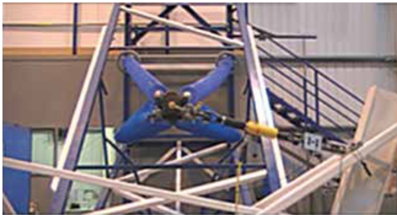
Фиг.9.14: Тестване на ранна версия с хидравлични системи, възпроизвеждащи състояния на прекъснат проводник.
